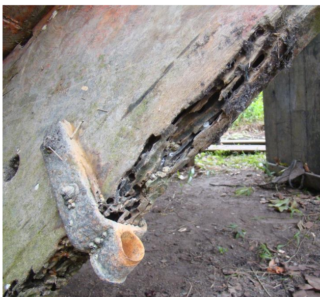
Peça da vigilenga denominada de 'cadastre' atacada por turú. No detalhe atracadeira de leme. Foto: Ailson Cardoso 2.000.
