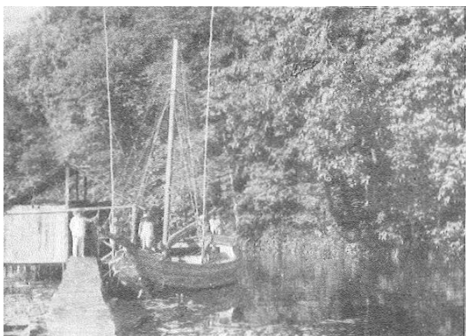
A canoa vigilenga “Carmita” no porto de Caraparú. — Seus tripulantes aparecem sustentando de pé os varejões, que vão ser utilizados no igarapé. O comprimento desses varejões é para compensar o tempo para empurrar a embarcação.
