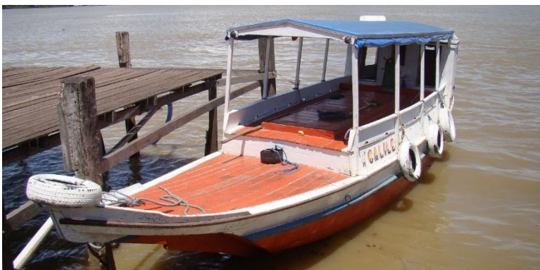
Canoa vigilenga motorizada transformada, na orla de Abaetetuba/2015, original apenas o casco. Foto: Ailson Cardoso/ney.
