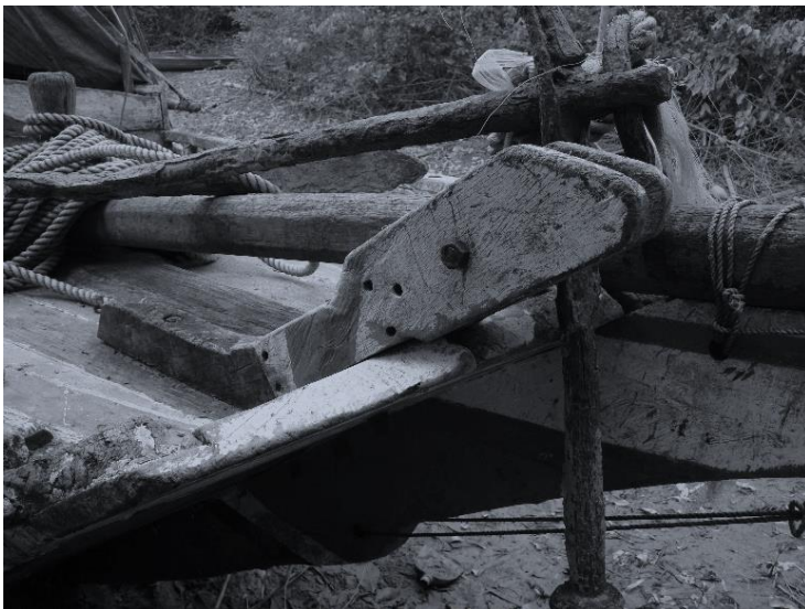
Em primeiro plano, o “Gigante”, peça de madeira com roldana fixada no lado direito da proa ao lado do “gurupé”, por onde se passava a amarra para soltar e puxar âncora. Acervo: Ailson Cardoso
