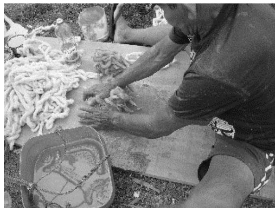
Calafate enrolando o pavio na coxa e embebendo com óleo vegetal. Foto: Ailson Cardoso. 2010.
